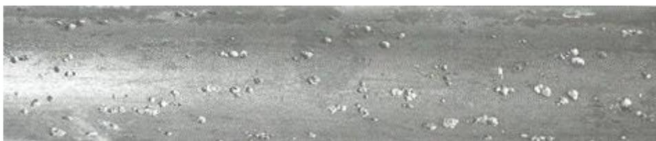
**Figura 2.29:** Corrosão uniforme em chapa de aço carbono (GENTIL, 1996).
