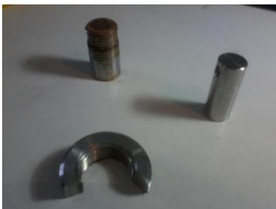
**Figura 4.9:** Amostras após o ensaio de corrosão.
