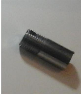
**Figura 4.8:** Pedaco de uma haste da válvula de segurança.
