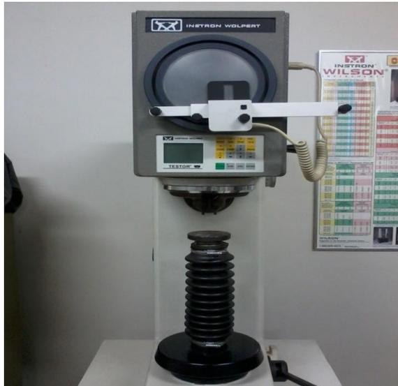
**Figura 3.2:** Máquina de ensaio de dureza Instron Wolpert modelo Dia Testor 7551 com mostrador digital.
